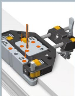
Rahmen und Flügel bohren. Anschlag DIN rechts/links beachten.
