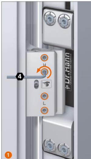
**Regulación horizontal ±2 mm (según necesidad en bisagra superior o inferior)** Aflojar tornillos de apriete ligeramente.
