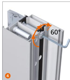
Wenn Buchsenkragen am Profil aufliegt, Inbusschlüssel drehen, bis drei Mal Widerstände zu spüren sind. Damit ist das Band fixiert!
