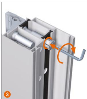
Spreizbuchse bis zum Buchsenkragen eindrehen.
