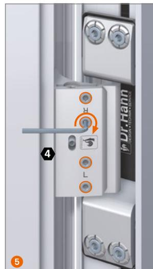
Klemmschrauben festziehen, 1,5 bis 2 Nm.
