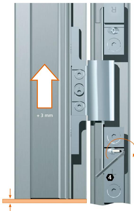
Zum Ausrichten des Türflügels in der Höhe Höhenverstellungsschraube um das entsprechende Maß drehen. Maximaler Verstellweg + 3 mm.
