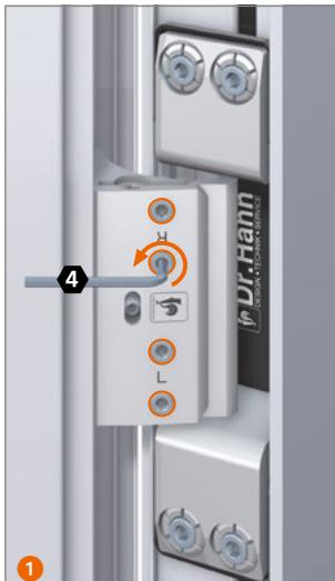
Регулировка по горизонтали  $\pm 2 \text{ mm}$  (по необходимости: на верхней и/или нижней петле).
