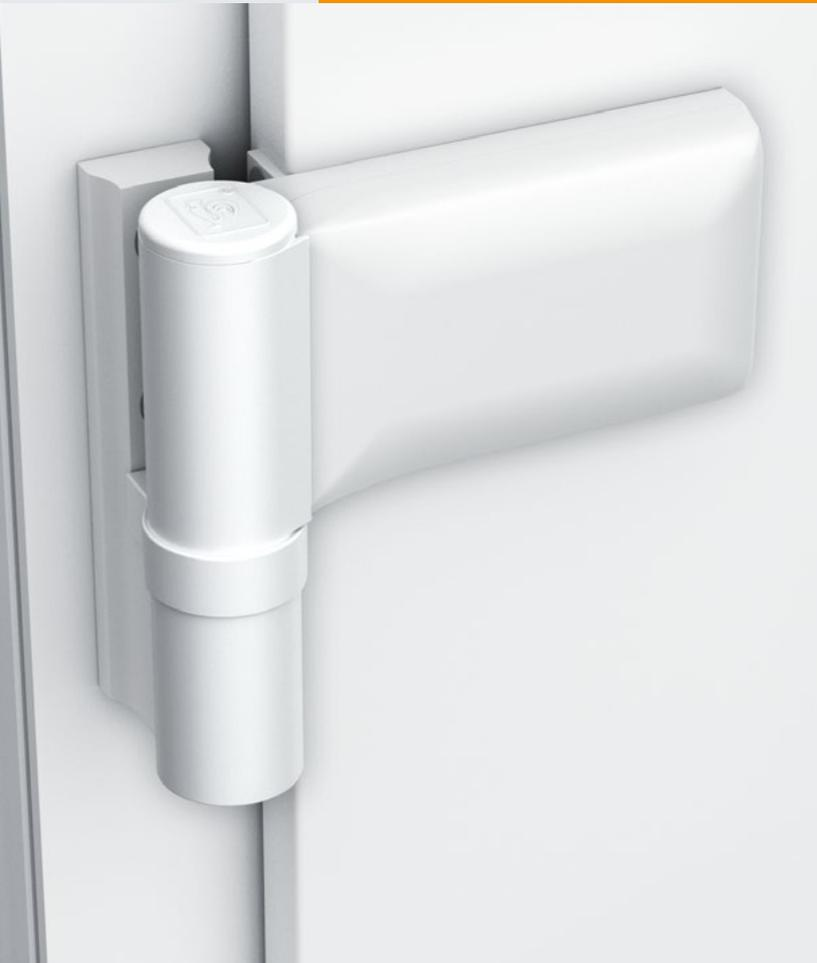
Las bisagras de Dr. Hahn de la serie KT-EV y KT-EN se desarrollaron para puertas hasta 120 kg. Tienen todo lo que necesita una bisagra para puertas: Son regulables en 6 direcciones, fáciles para montar y rápidas para ajustar. Ambas versiones existen con tornillos auto-perforantes, que reducen aún más el tiempo de montaje.
