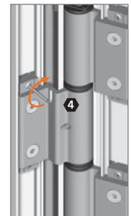
**Apretar clavijas roscadas (máximo 4 Nm).**
