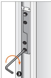
**Si es necesario fijar contra-pieza ligeramente con clavija roscada. (¡sin apretar!)**
