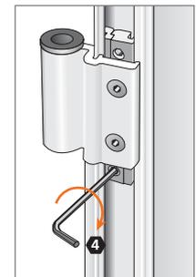
**Apretar clavijas roscadas (máximo 4 Nm).**
