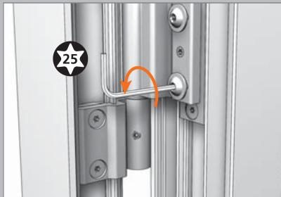
Retirar tornillos de fijación del elemento de la hoja.
