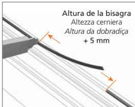
Recortar junta de la hoja en toda la altura de la bisagra.
