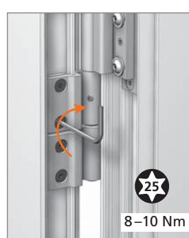
Atornillar de nuevo los tornillos de fijación de **todas** las bisagras y retirar la herramienta de regulación vertical.
