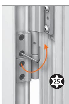
Desatornillar los tornillos de fijación del marco **de todas** las bisagras.
