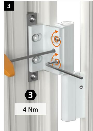
**Regulación presión de cierre · Regolazione della pressione sulla guarnizione · Regulagem pressão na verdação**
