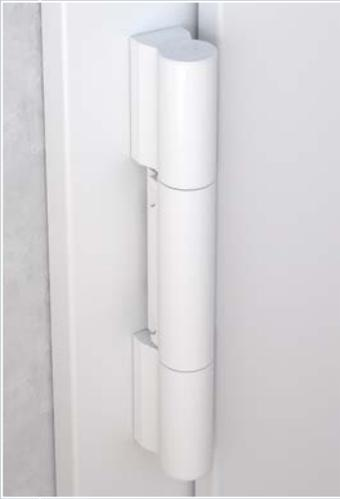
Trotz seiner schlanken Form trägt das KT-RN je nach Profilsituation bis zu 140 kg. Je nach Profilgeometrie bedient das KT-RN mit einer Variante viele der im Markt gebräuchlichen Profilausführungen mit einem rechtwinkligen Aufdeck von 16,5 bis 26,0 mm. Im gleichen Aufdeckbereich ermöglicht eine weitere Band-Variante mit einer speziell dafür entwickelten Flügelband-Kontur den Einsatz für Profilkombinationen mit einem winkligem Aufdeck zwischen 4° und 6°.
