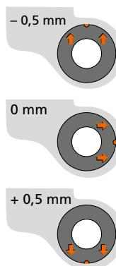
Markierung am Buchsenkragen zeigt am oberen und unteren Rahmenband nach der Verstellung nach hinten.
