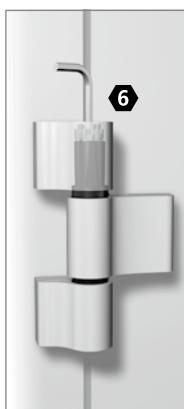
Lagerbuchse um  $\pm 90^\circ$  drehen bis sie spürbar einrastet.
